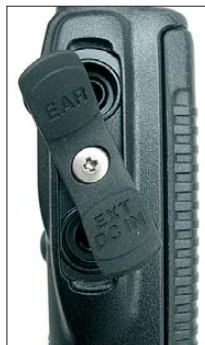
Bild 3: Die Kopfhörer- und Stromversorgungsbuchse werden wasserdicht abgedeckt.
