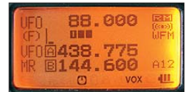
Bild 20: Drei Frequenzen werden simultan überwacht.
