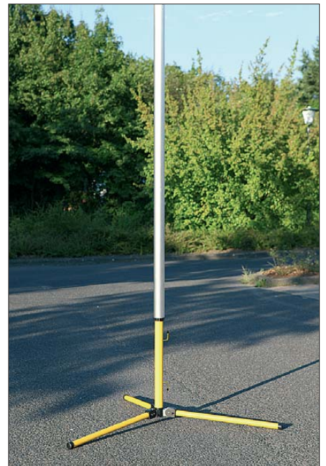
Bild 2: Ein Dreibeinstativ eignet sich als vorübergehende Basis für eine Fahnenmastantenne. Fotos: DL1ABJ
