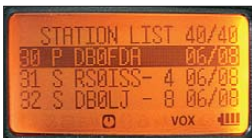
Bild 10: Empfangene APRS-Stationen werden automa- tisch in eine Liste eingetragen.
