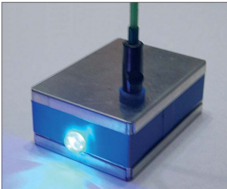
Bild 1: Bei der Detektion einer positiven Aufladung leuchtet die LED hell auf.
