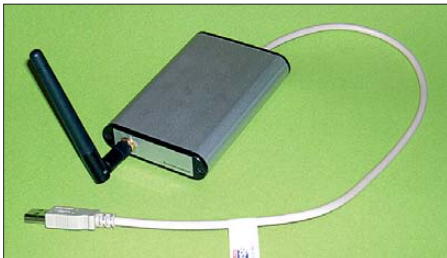
Bild 1: Das USB-Interface ist in einem Aluminiumgehäuse untergebracht.
