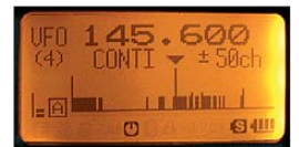
Bild 19: Die Spektraldarstellung läuft über 100 Kanäle.
