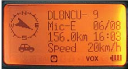
Bild 7: Anzeige einer empfangenen APRS-Station mit Entfernung und Richtung
