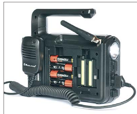
Seitlich liegen eine LED-Lampe sowie Buchsen für ein externes Lautsprecher-Mikrofon. Das rückseitige Batteriefach nimmt gleichzeitig den mitgelieferten Akkumulator und Mignon-Zellen auf.
