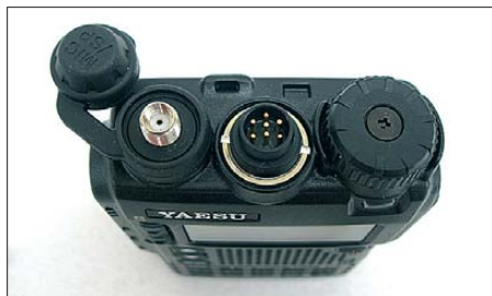
Bild 2: An der neuartigen Mikrophonbuchse liegen auch die GPS-Signale an.
