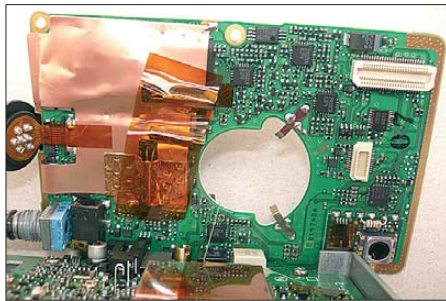
Bild 17: Quarze und Speicherchips auf der Tastaturplatine; rechts unten das Sensormodul
