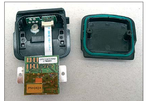
Bild 13: Blick in das GPS-Modul, ein Knopfzellenakkumulator erhält die Almanachdaten auch im stromlosen Zustand.
