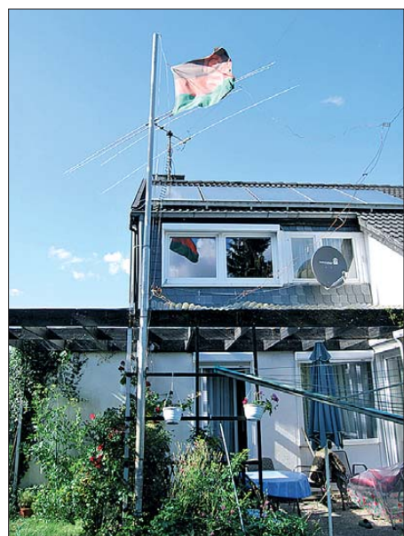
Bild 1: Mit wenig Aufwand lässt sich ein Fahnenmast als KW-Antenne verwenden.
