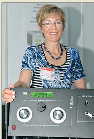
Das Antennenanpassgerät AT5K Plus der schweizerischen Heinz Bolli AG arbeitet von 1,8 bis 52 MHz im Bereich von 10 bis 2000 \Omega ; Dauerlast: 4,5 kW.
