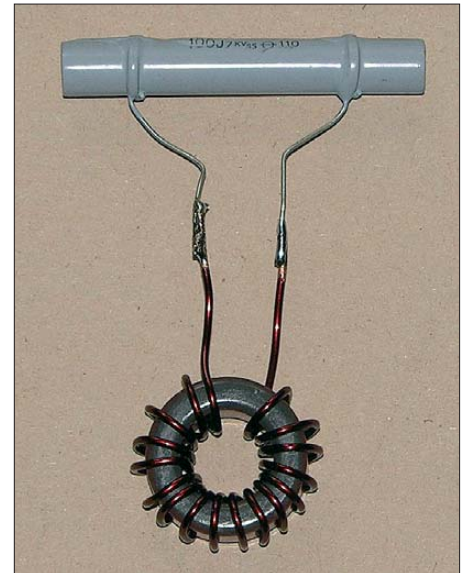
Bild 5: Komplett aufgebaute Sperrkreis für eine Resonanzfrequenz von 10,1 MHz mit 17 Windungen auf einen Ringkern T94-2 (Induktivität 2,45 \mu\text{H} ) und einem Parallelkondensator (Kapazität 100 pF)
